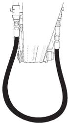
2. Kör hydrauloljan genom bärarens oljefilter i ungefär 3 minuter så att slangarna blir rena.
