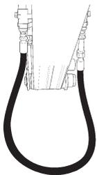
2. Прокачайте гидравлическое масло по кругу через масляный фильтр экскаватора в течение примерно 3 минут, чтобы как следует прочистить шланги.
