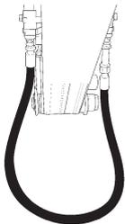
2. Lad hydraulikolien løbe gennem bæremaskinens oliefilter i ca. 3 minutter, for at sikre at slangerne er rene.
