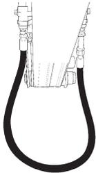
2. Kjør hydraulikkoljen gjennom bærerens oljefilter i ca 3 minutter for sikre at slangen er ren.
