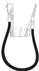
2. Laissez l'huile hydraulique passer à travers le filtre à huile de l'engin porteur pendant 3 minutes environ pour s'assurer que les flexibles sont propres.
