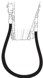
2. Laat de hydraulische olie ongeveer 3 minuten door het oliefilter van de drager stromen om er zeker van te zijn dat de slangen schoon zijn.
