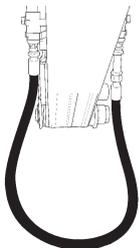
2. Lassen Sie das Hydrauliköl für ungefähr drei Minuten durch den Filter des Trägergeräts laufen, um sicherzustellen, dass die Schläuche sauber sind.
