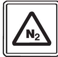
L'accumulateur ne peut être chargé qu'avec de l'azote !
